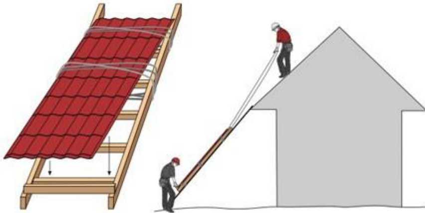
Переноска листов металлочерепицы на кровлю
